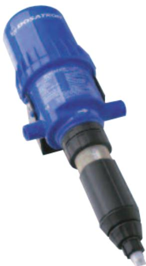
Bei Dosatron handelt es sich um ein wasserdruckgesteuertes Modell, das stoppt, wenn die Anforderung bei Null liegt. Es handelt sich um eine Druckpumpe, die über einen breiten Temperaturbereich und eine große Durchflussmenge hinweg eine konstante Mischung liefert und leicht justierbar ist. Venturi-Mischer sind weniger kostspielig, sind aber weniger zuverlässig und langfristig sind Druckpumpen die wirtschaftlichere Variante.
